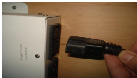
Conectarea intre incalzitor si sursa de energie
